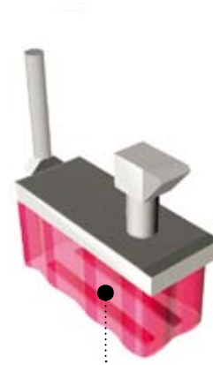
Figure 7 : Toute la zone située à l'intérieur des rideaux constitue un lieu dangereux de classe I, zone 1.
