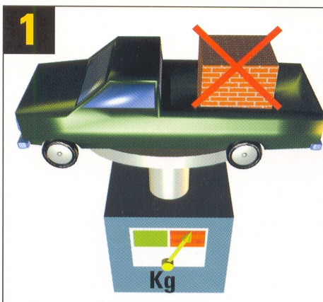
Respecter la capacité de levage
