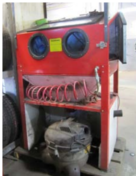
Le cabinet développé chez Hyundai Trois-Rivières protège le travailleur contre les projections.
