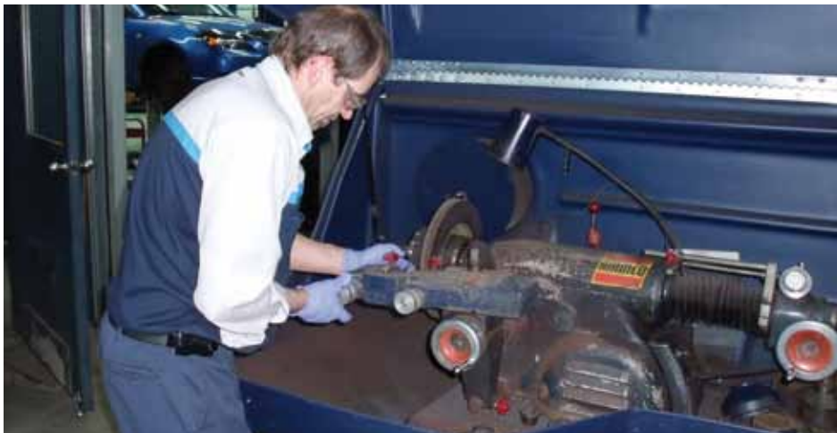
Rénauld Gagnon de L'Ami Junior Mazda procède à l'installation du disque sur le tour à frein.
