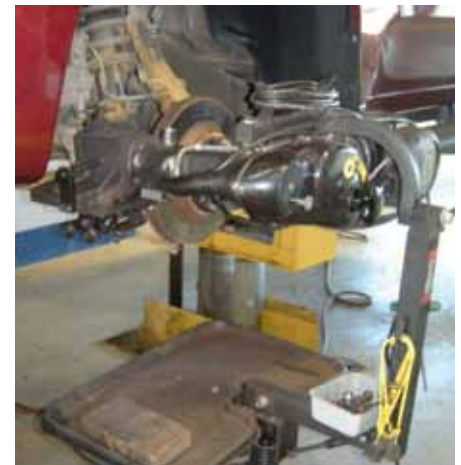
Voici le tour à frein monté sur véhicule utilisé par Marquis Automobiles de Matane.
