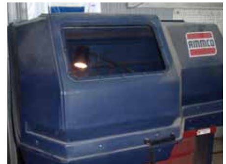
L'utilisation de l'enceinte permet de éviter la projection de poussières dans l'air.
