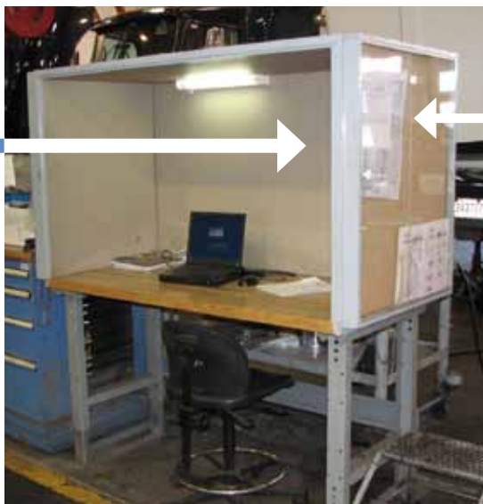
La lecture prise à l'extérieur de l'enceinte montre un niveau de bruit de 78 dB(A).
