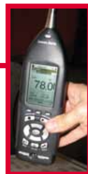
La lecture prise à l'extérieur de l'enceinte montre un niveau de bruit de 78 dB(A).
