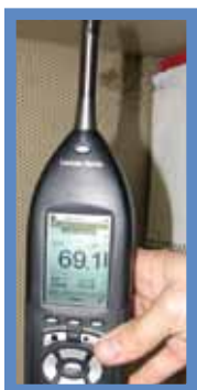
La lecture prise à l'intérieur de l'enceinte montre un niveau de bruit de 69,1 dB(A).
