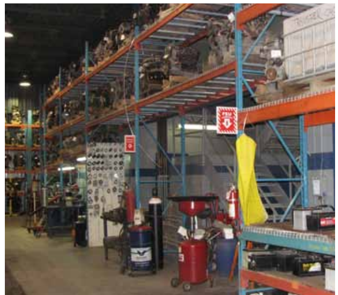
Les pièces lourdes et les moteurs sont entreposés sur des étagères dont la capacité a bien été évaluée.
