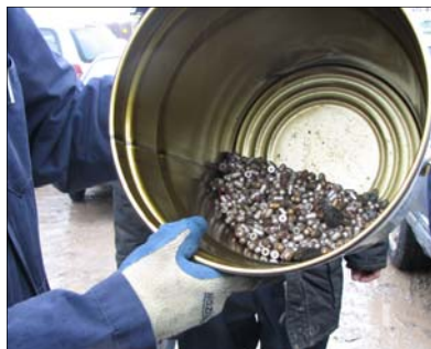
Les composantes récupérées doivent être prises en charge exclusivement par une entreprise spécialisée pour les déchets mercuriels.
