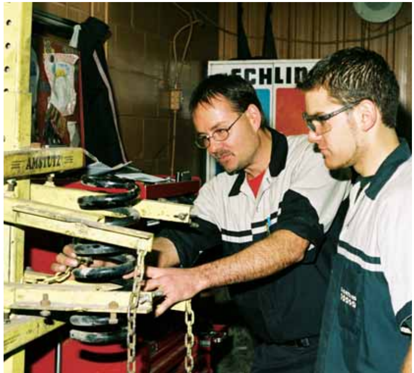
Un technicien d'expérience explique à un nouveau travailleur comment installer un ressort de façon sécuritaire sur l'appareil de compression.
