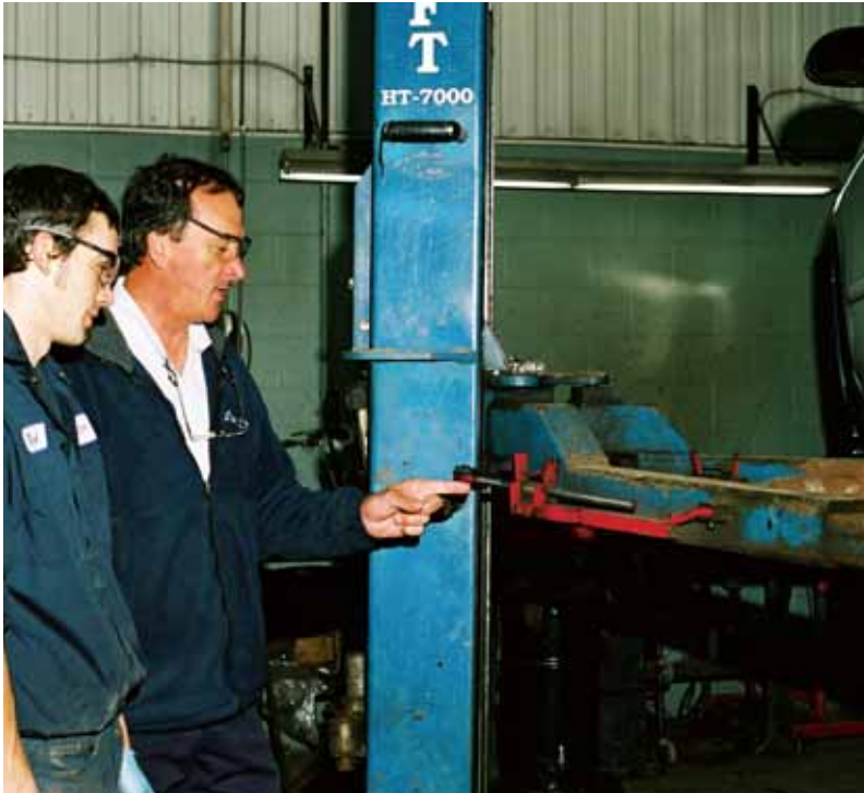
Lorsqu'on soulève un véhicule, il est important de s'assurer que le dispositif de blocage des bras articulés est en place pour les empêcher de tourner. Le technicien explique ici comment vérifier ce dispositif de blocage.
