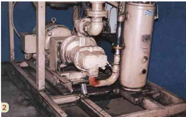
2 Le compresseur a été posé sur un tapis de caoutchouc qui amortit le bruit des vibrations.
