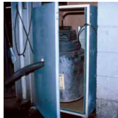
Ce coffre, dont l'intérieur est isolé avec du Sonopan (un matériau insonorisant rigide), permet de réduire le niveau de bruit de cet aspirateur d'atelier de 15 décibels.
