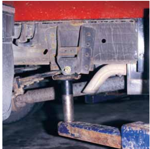
Pour les véhicules à cabine ou à châssis allongé, le point de levage se situe généralement à la jonction de la lame de ressort et du châssis.
