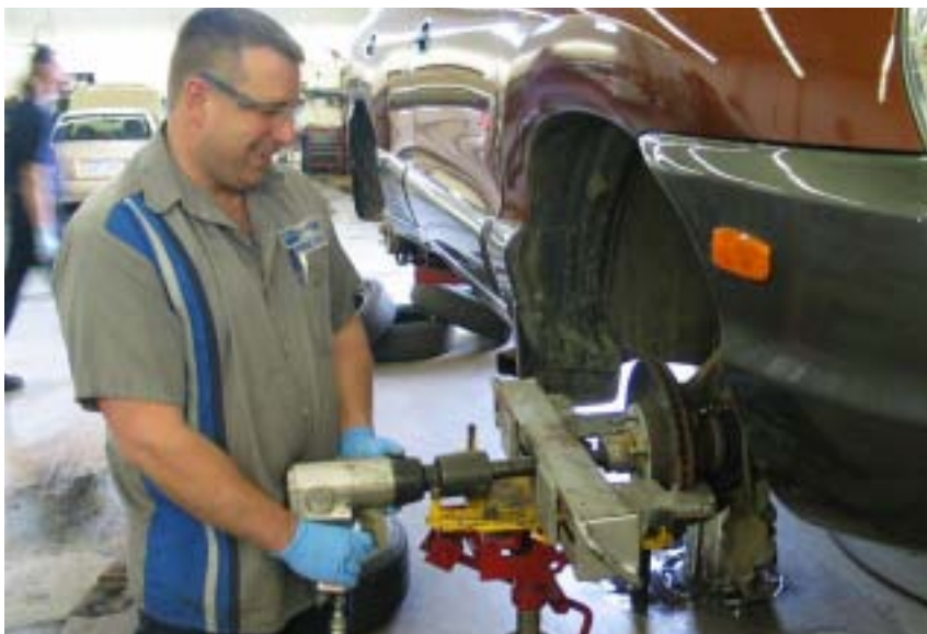
Le technicien FRANÇOIS ÉMOND extrait un disque de frein en toute sécurité, grâce à l'extracteur développé par Automobiles GR Corée .
