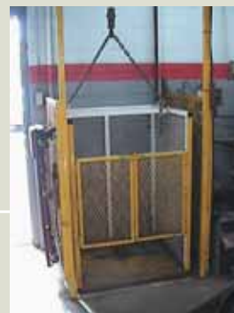
Le monte-charge est utilisé pour le transfert des roues complètes.
