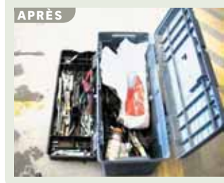
AVANT : coffre de métal surchargé (50 lb) APRÈS : coffre en plastique renforcé et tri des outils (30 lb)
