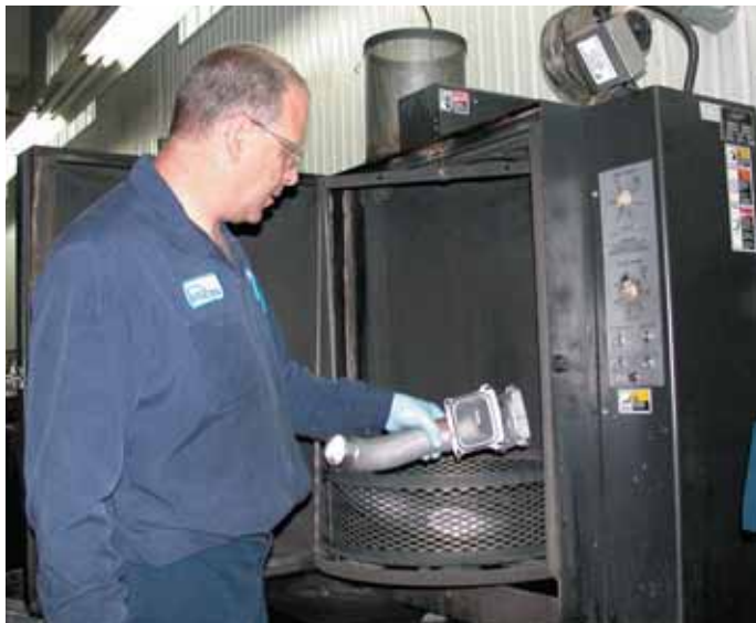
Le cabinet à aspersion fonctionne généralement automatiquement et demande peu d'intervention. Un article paru dans le numéro de mars 2003 d'Auto Prévention faisait la démonstration de sa rentabilité.
