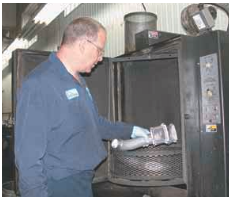
Jean-Eudes Gauthier, technicien en mécanique chez PACO Chevrolet Oldsmobile à Ville Saguenay, utilise régulièrement le lave-pièces automatique.
