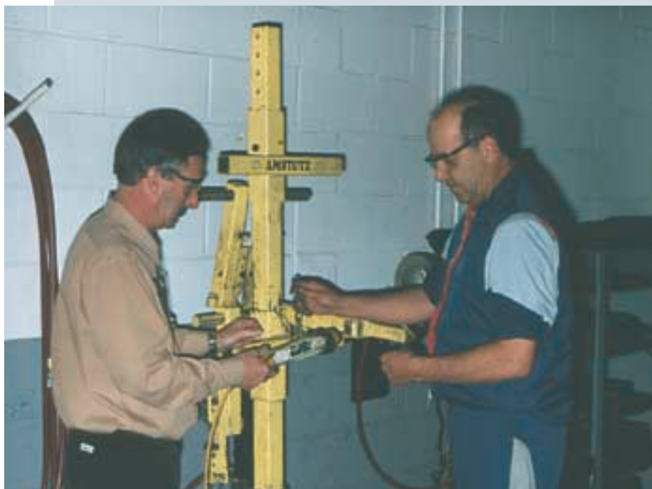
À la suite de la parution d'un article dans le magazine Auto Prévention concernant la compression des suspensions McPherson, l'entreprise n'a pas hésité à remplacer l'appareil en service par un appareil plus sécuritaire.
