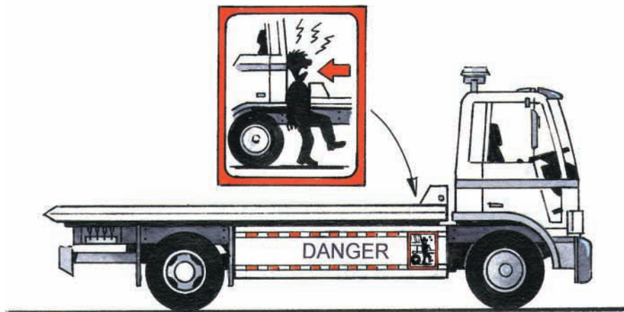
Contrôle du point de coincement par la jupette
