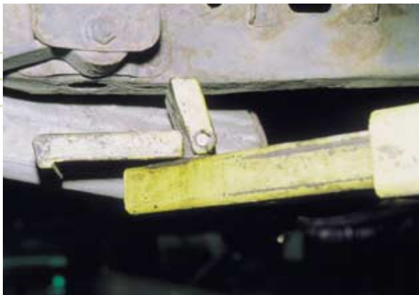
▲ Une fois soulevé, le véhicule doit être droit et n'être retenu que par les points d'appui recommandés.
