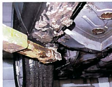
LES PATINS. Des patins en bon état et solidement fixés au pont élévateur : voilà un autre point à surveiller lors de l'inspection.
