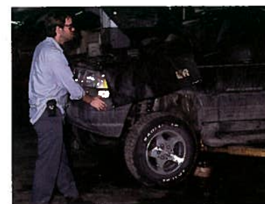
LA STABILITÉ DU VÉHICULE. Après avoir levé le véhicule de quelque 15 ou 20 cm, le mécanicien donne une petite poussée pour en vérifier la stabilité.
