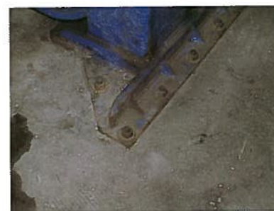
LES POINTS D'ANCRAGE. Le couple de serrage des boulons d'ancrage doit être vérifié périodiquement, conformément aux recommandations du fabricant. Il faut également surveiller la qualité du béton, car un béton dégradé — notamment par les abrasifs — n'assure pas la même prise qu'un béton neuf en bon état.
