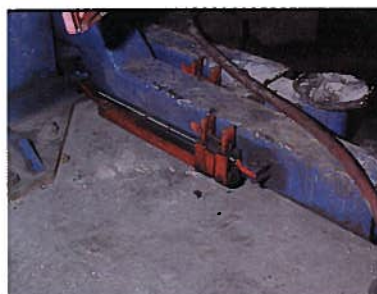
BLOCAGE DES BRAS ARTICULÉS Les bras articulés de la superstructure doivent être munis d'un dispositif de blocage fonctionnel.
